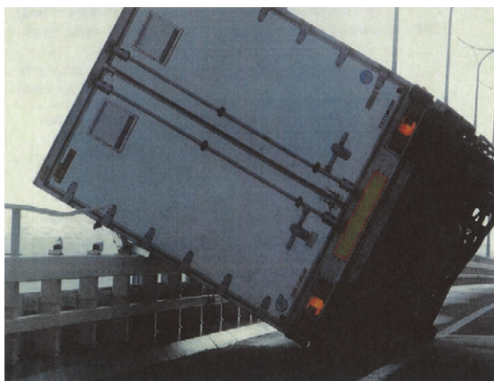
図-1 横風による横転事故（東京湾アクアライン）
